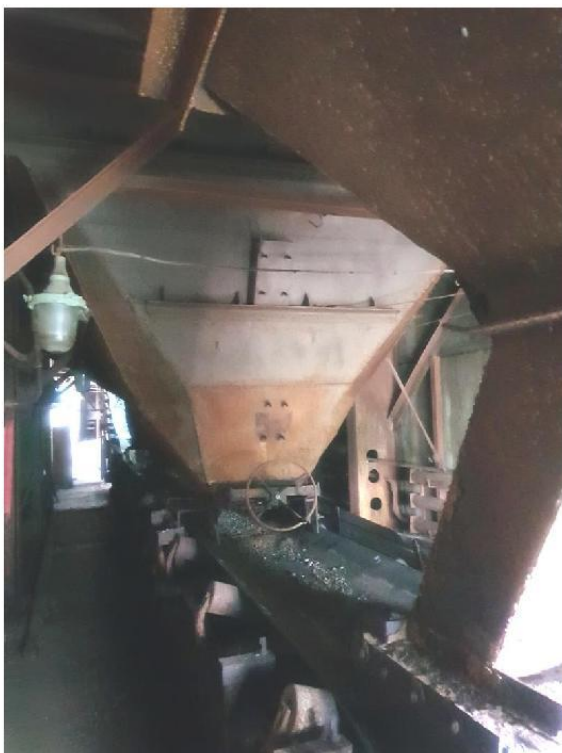
Фото № 1 выгрузка с бункера на конвейер
